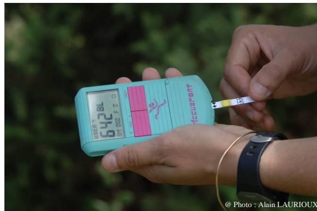
Figure 14 : Mise en place de la bandelette.
